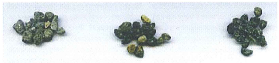
Het slijtingsproces van olivijnsteentjes na resp. 1 dag (midden) en tien dagen schudden (rechts)
